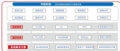
中凯云平台是在低压电器技术及发展趋势的基础上，总结国内外同类产品的先进经验，采用物联网（IOT）、移动APP、云计算、可视化等先进技术研发的新一代综合监控和管理功能的集成系统平台。
