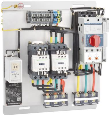
以KB0作为主开关，与接触器、时间继电器、电气联锁等附件组合，构成Y-△减压起动器成套单元KB0J（以KB0-F消防型产品作为主开关，可构成消防型Y-△减压起动器成套单元KB0J-F）可实现110kW及以下的电动机的Y-△减压起动控制与保护。
