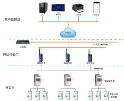
基于中凯智能管理平台的智能配电系统以KBO智能配电型控制与保护开关电器+智能微断构建智慧用电数据平台，实现用电设备的智能化管理，终端用电数据实时监测，数据上传，平台分析。为以实现安全用电、智慧用电、能源管控、项目运维，提供更好的解决方案和服务。
